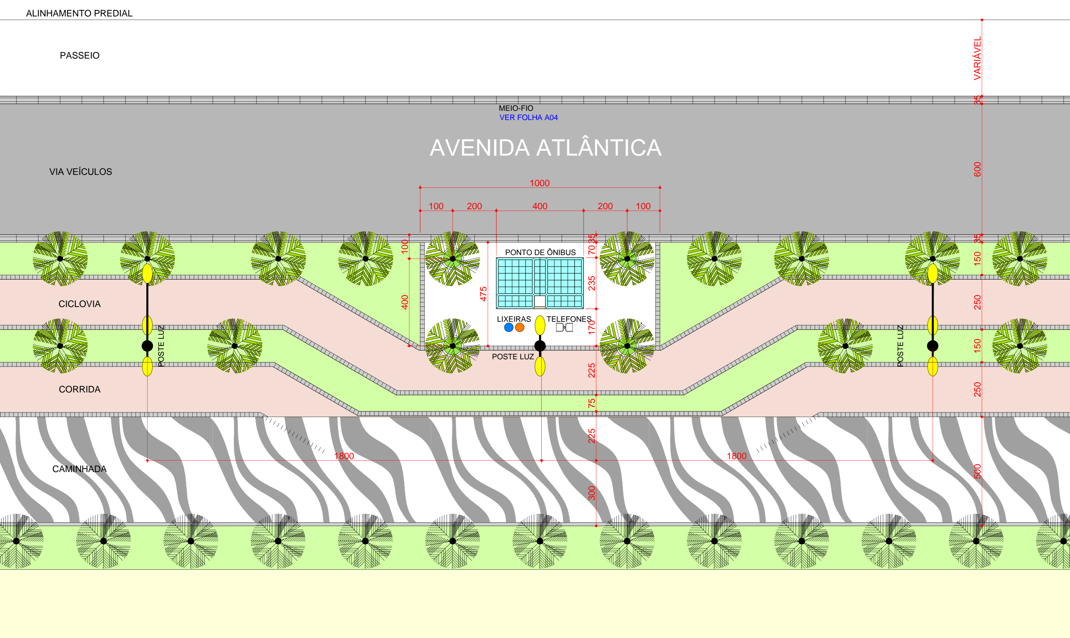
PLANTA PADRÃO GENÉRICA PONTO DE ÔNIBUS AV. ATLÂNTICA ESCALA 1:100
