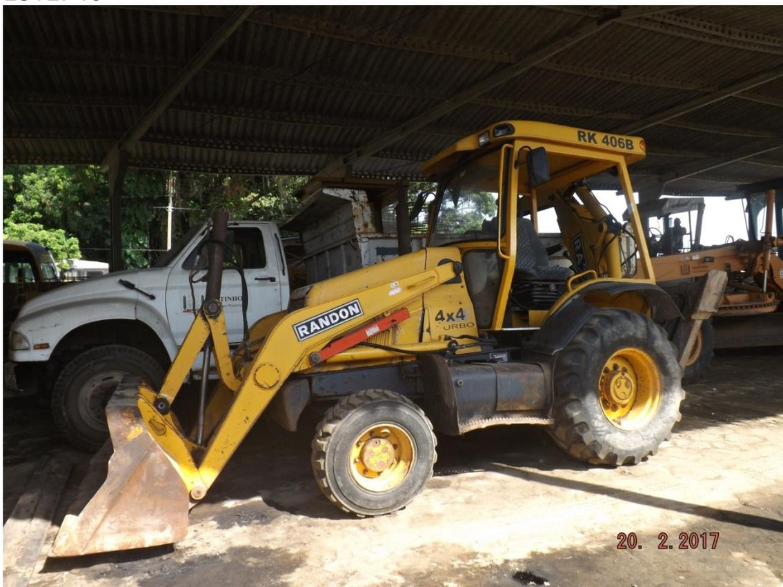
RETROESCAVADEIRA HIDRÁULICA: MODELO RANDON RK 406B - ANO DE FABRICAÇÃO: 2006 - SERIE: 621B031 - COR: AMARELA - COMBUSTÍVEL: DIESEL
